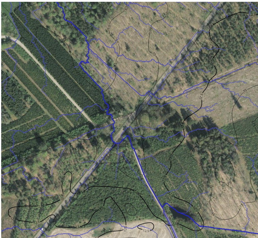
Figur 2: Rørunderføringen ønskes etableret, da Trafik og Vej har udfordringer med vand på vejen. Vandet på vejen skyldes den naturlige afstrømningsvej ifølge analyser fra SCALGO Live, et avanceret hydrologisk analyseprogram. Programmet anvender detaljerede topografiske data til at identificere og visualisere vandstrømningsveje samt potentielle oversvømmelsesområder. De blå streger i figuren angiver de kortlagte strømningsveje, hvor en kraftigere blå farve indikerer en højere forventet vandgennemstrømning.
