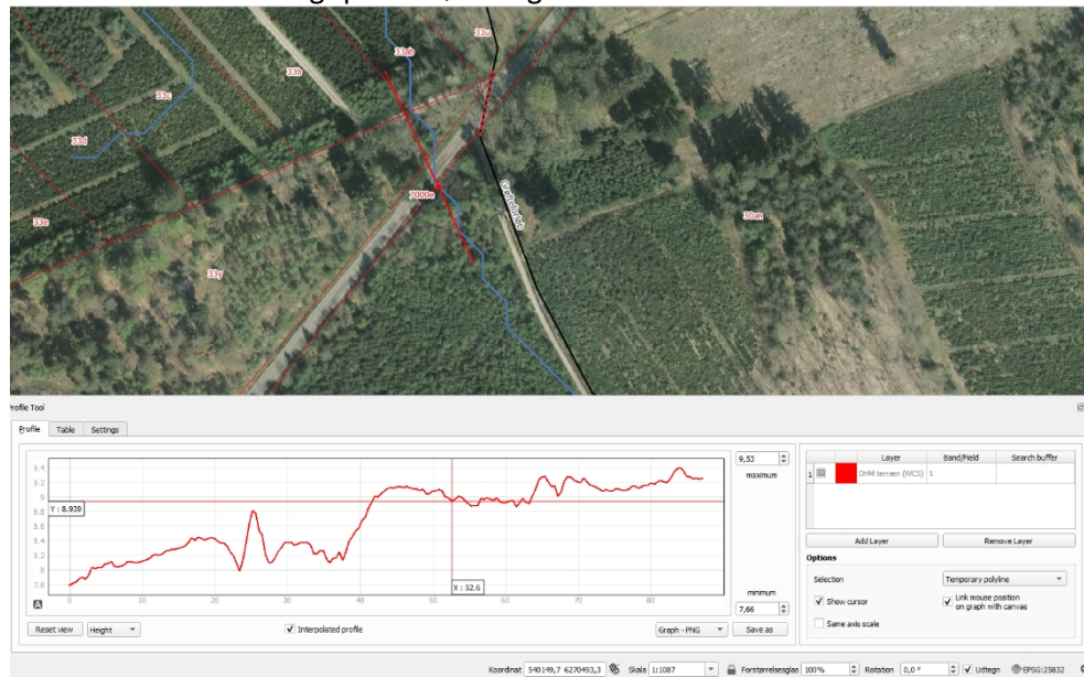
Figur 3: Kort med højdeforløb (rød streg) og afstrømningsvej (blå streg).
