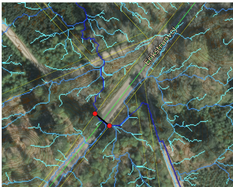
Figur 1: Angivelse og markering af hvor den nye rørunderføring under Erikstrupvej ønskes etableret. De to runde cirkler angiver vejbrønde på begge sider af vejanlægget.
